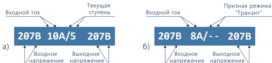
**Рисунок 5.2 - Примеры изображений на индикаторе стабилизатора («начальный экран») а) в режиме «Стабилизация»; б) в режиме «Транзит»**
